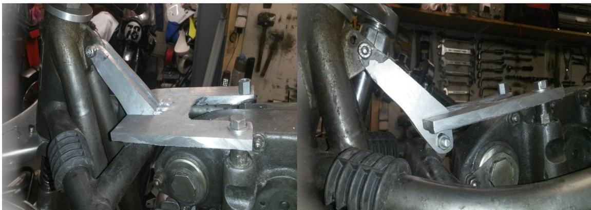
Ebauche d'une platine alu pour fixer le haut moteur au cadre. Plus bas, montage du train avant.
