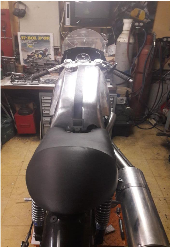
le réservoir d'huile est revenu de soudure. Tous les tuyaux d'huile sont raccordés et la phase finale approche, le démarrage. Entre temps, le réservoir d'essence partira en modification afin de souder un évent sur la partie supérieure droite( travail effectué par Réplica bikes à Argenteuil). Il en profitera aussi pour refaire des soudures pas étanche à l'essence...
