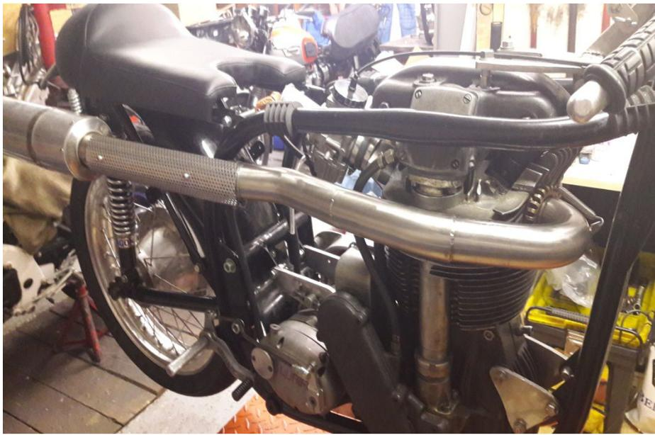
Finalisation du train avant. La roue est revenue de chez Seurat. Montage du 4 comes et fabrication "maison" de platines alu pour fixer les flasques aux fourreaux de fourche. La tête de fourche est une classique fly screen provenant d'une vraie manx. Le garde -boue avant provient de <http://breizhpolyracer.eu/>
